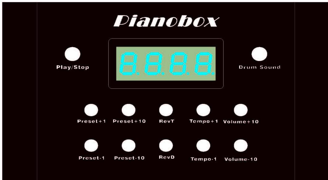
Die 10 Funktionstaster sind jeder für eine bestimmte Funktion der Pianobox USB verantwortlich, mit jeder einzelnen wird eine bestimmte Funktion greifbar. Dabei gibt es zwei Ebenen, die Drum-Ebene und die Sound-Ebene.
